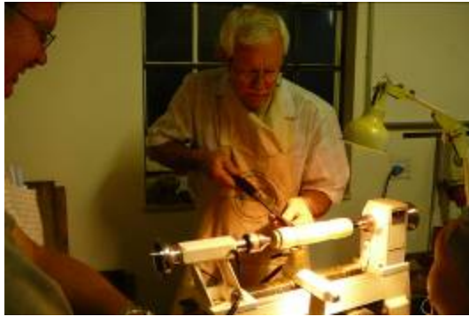
Lou Coetzer demonstreer draaitegnieke tussen spilpunte. (Wys sommer ook hoe om 'n apparaat te maak om die moegheid uit ou voete te kry!)
